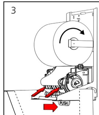
Die Papierrolle im Uhrzeigersinn drehen und das abgewickelte Papier an der angegebenen Position (zwei graue Pfeile) zwischen den beiden Rollen einführen. Danach solange die PUSH-Taste drücken, bis das Papier fest zwischen den Rollen sitzt.
