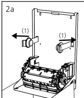
Gerät befüllen. Hierfür bitte die Flügel (1) links und rechts leicht nach außen biegen.
