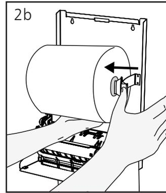
Die Rolle an die Position setzen und die Flügel zurückschnappen lassen, so das die Führungen der Flügel in den Rollenkern einrasten.
