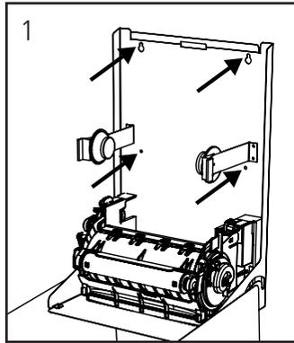
Gerät mit 4 Schrauben und Dübeln befestigen.
