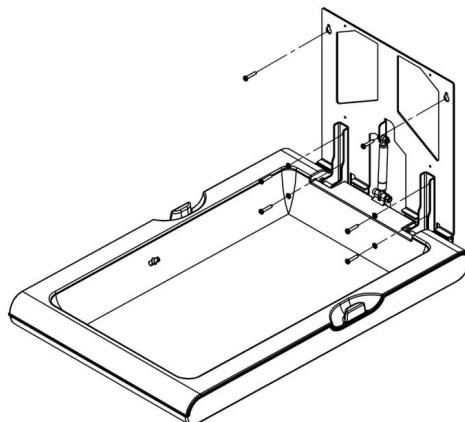
Zorg ervoor dat de zes schroeven waarmee de tafel aan de muur is bevestigd, goed zijn aangedraaid en dat de verschoontafel stevig aan de muur is gemonteerd.
