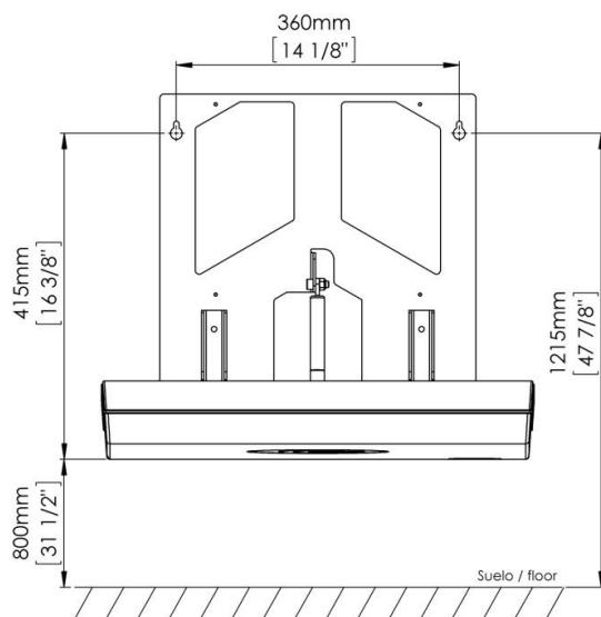
Siguiendo el esquema anterior marcar con el lápiz, sobre la pared, los dos agujeros superiores de la estructura de sujeción del cambia pañales. Es muy importante asegurar que las ubicaciones que se hayan marcado a lápiz para los agujeros de montaje estén al mismo nivel antes de realizar las perforaciones.
