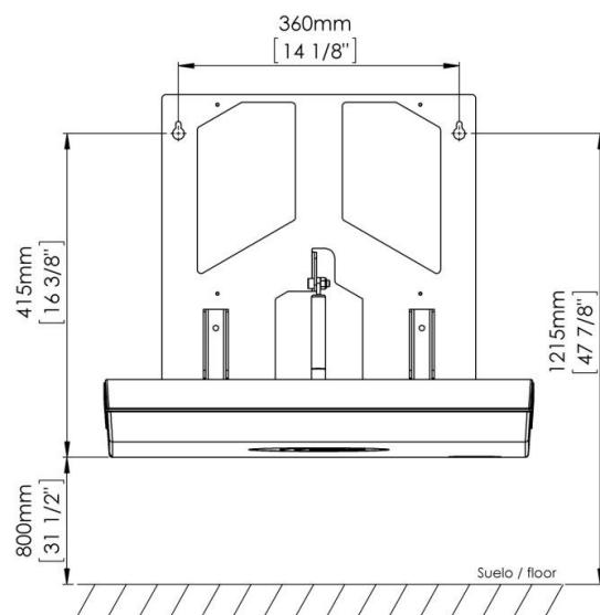
In base al disegno precedente tracciare a matita, sulla parete, i punti in cui realizzare i due fori superiori della struttura di fissaggio del fasciatoio. Prima di trapanare, è fondamentale verificare che i punti dei fori di montaggio tracciati a matita si trovino alla stessa altezza.
